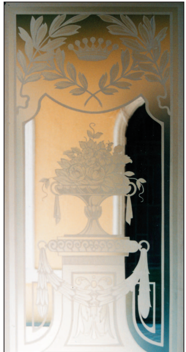
Baross utca 41. lakóház, Budapest VIII. - lépcsőház, többtónusú savmaratással készített ajtóbetétek rekonstrukciója - vektorizált kartonrajz
