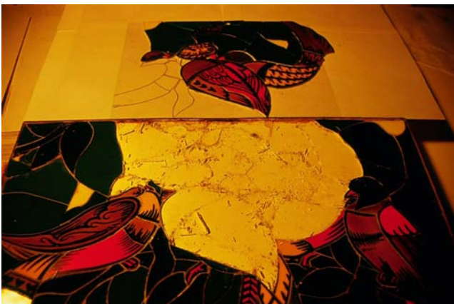
Az üvegtér gipszágyazattól elvált részei - a felületből kiemelt, elvált üvegszemek - gipszágyazat
