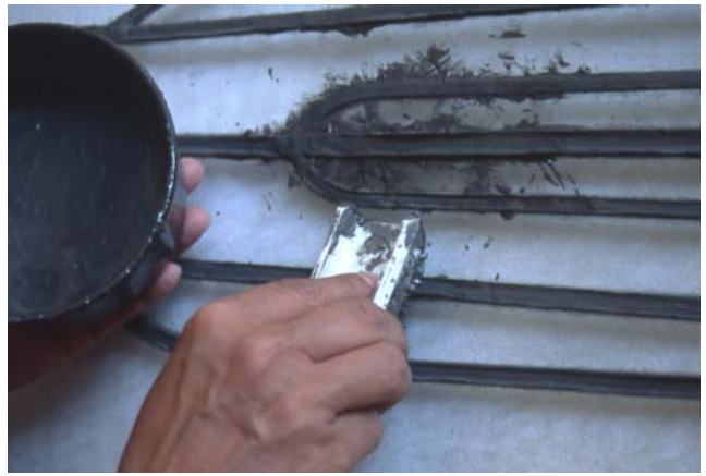
Felnyitott ólomsínek hézagtömítése
