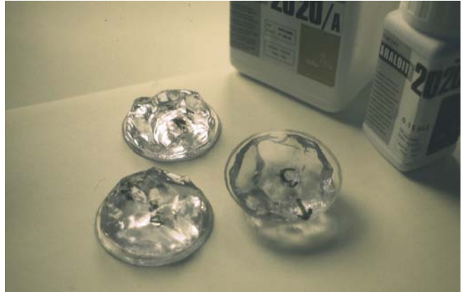
Plasztikus üvegbetétek rekonstrukciója
