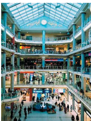
18. ábra A belső udvar szintén gazdag, a padló többféle nemes kő, a korlát edzett üveg. Az üzletek válaszfala a cégek arculatához illeszkedik. A ragyogó világítás az állmennyezetbe épített fényforrásokból árad.
