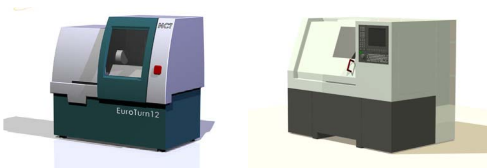
Szabadon balra nyíló pados felépítmény: Euroturn 12 és 12-b
