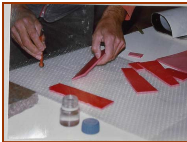
Üveglepény szabása petróleumba mártogatott görgővel. Ezek a darabok vidia-betétes csípőfogóval alakíthatók tovább.
