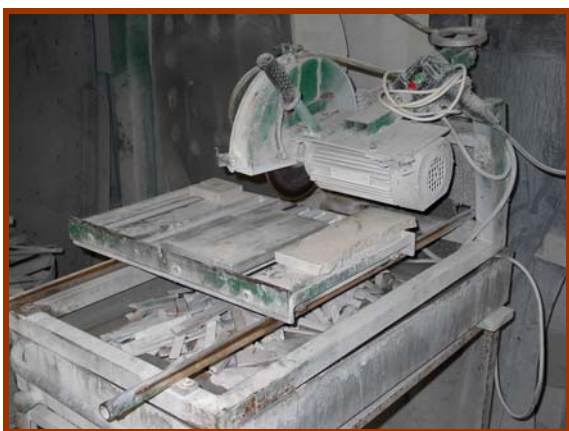
Vízhűtéses, gyémántkorongos kővágó gép.
