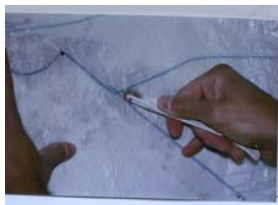
A segédvonalak felrajzolása a kristálypapírra, és végigluggatásuk.
