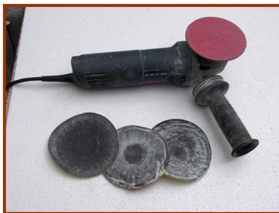
Állítható fordulatszámú sarokkösörű. Különféle munkatárcsák felszerelésével mindenféle használható: az ék élezésére, kövek vágására, csiszolására.
