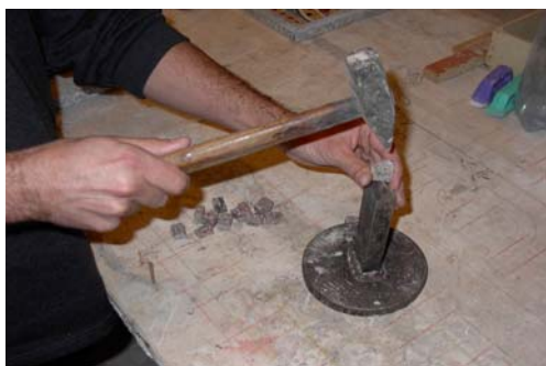
Kőtörés a klasszikus kézműves módszerrel, acél éken, kalapáccsal
