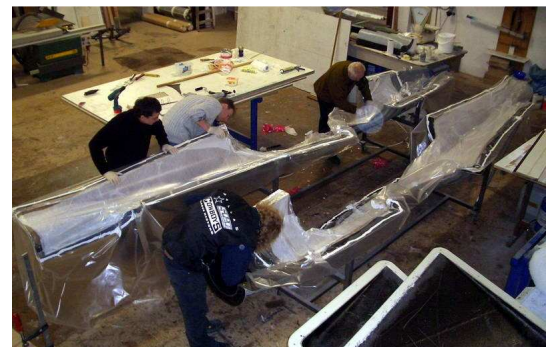
62. Prepreg törzselemek előkészítése a levegő kiszívtyúzásához (Silence-Aircraft)
