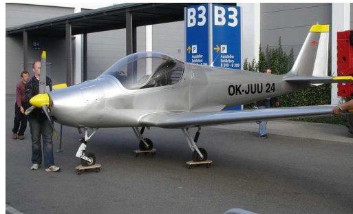
70. A Rapid lemeztechnikával készült
