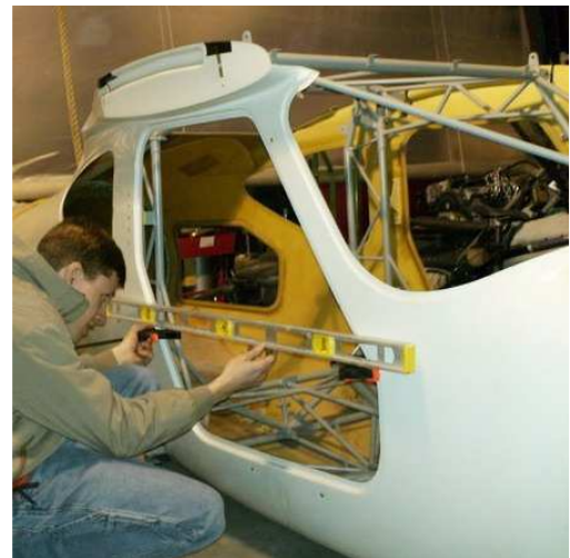
63. Egy Glasair gép vázszerkezetének és a kompozit törzs szerelése
